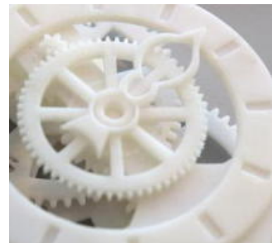
Uhrwerk aus dem 3D Drucker, an einem Stück gefertigt.
