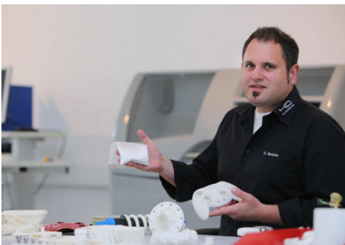
Daniel Nedele mit Bauteilen und einer Tüte Polyamid, das in den Drucker eingefüllt wird.
